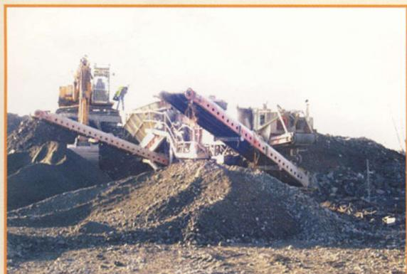
Après s'être entendu sur les modalités techniques de valorisation des bétons des bâtiments de la fonderie, et la réalisation de contrôles de la qualité du béton concassé produit, le chantier fut mis en œuvre avec succès en couche de forme des nouvelles voiries.
